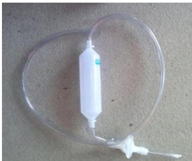
Abb. 82 handbetriebene Kraftstoffabsaugvorrichtung Quelle IdF Münster
