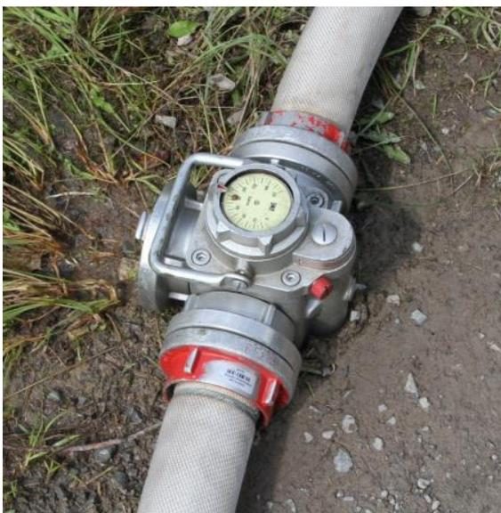
Am Überlauf des Druckbegrenzungsventils kann ein B-Schlauch zur Ableitung des Wassers angekuppelt werden. Die Länge dieses Schlauches darf jedoch nicht mehr als 5 m betragen.
